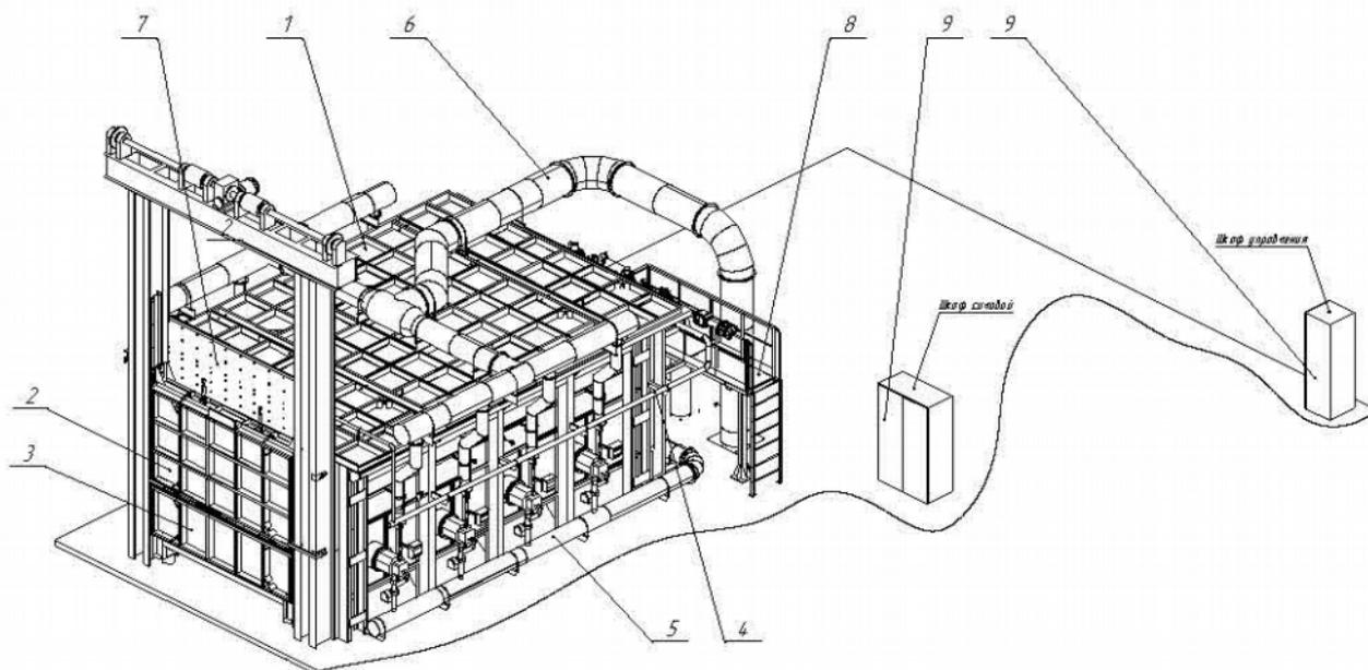
Конструктивно печь состоит из: каркаса камеры 1, заслонки подъемной 2, системы транспортной 3, разводки газовой 4, разводки первичного воздуха 5, отвода продуктов горения 6, футеровки 7, площадки обслуживания 8, системы управления 9.
